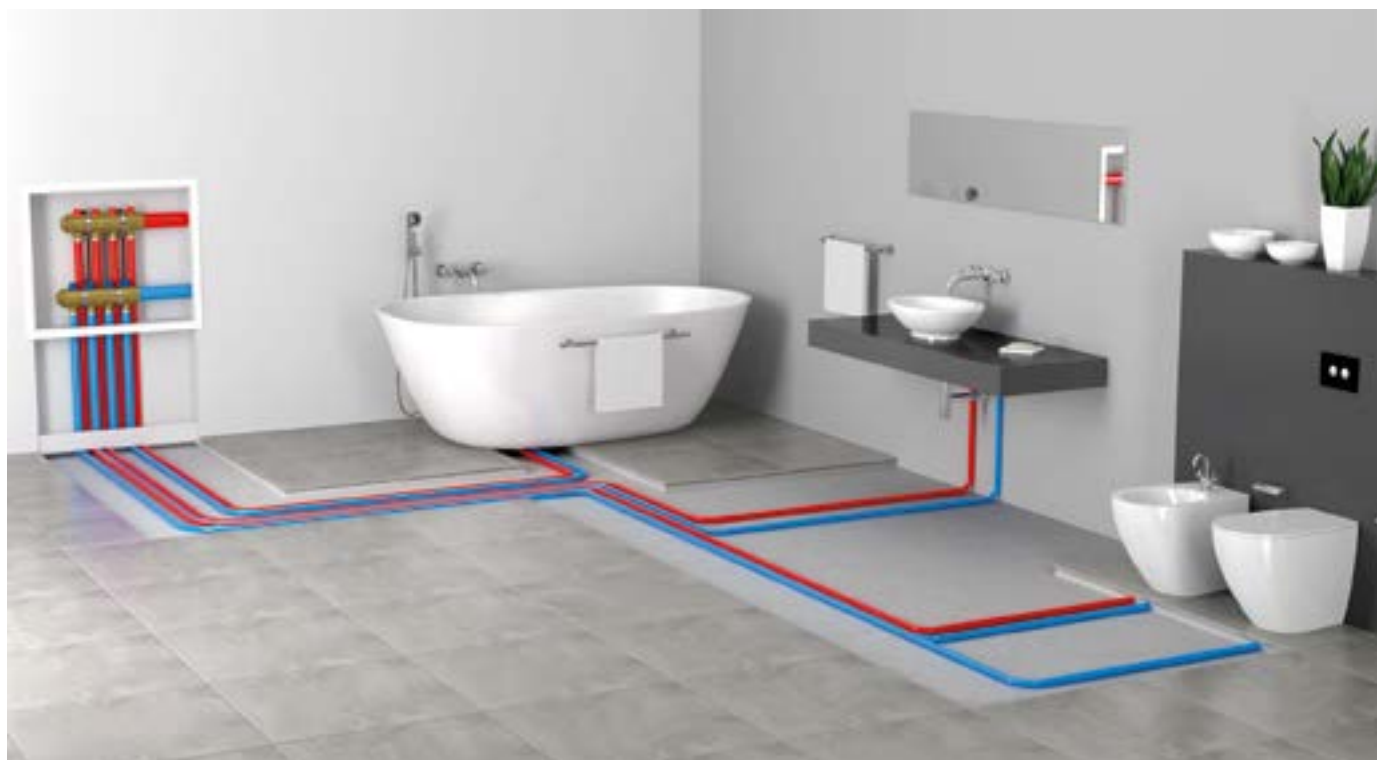
Installation sanitaire réalisée avec du tube multicouche pré-isolé ou avec une gaine de protection annelée colorée
